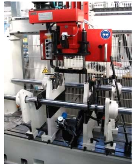
Bohreereinrichtung mit Späneabsaugung
