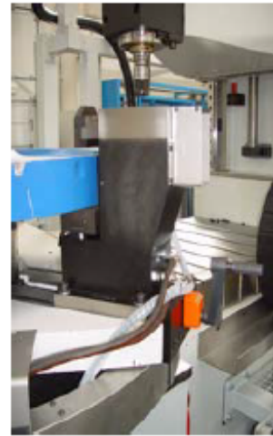
1 Unwucht messen, 2 Fräseinheit, 3 Schaltschrank, 4 Spänesauger, 5 Hydraulik Spannblock mit Schnellwechselsystem
