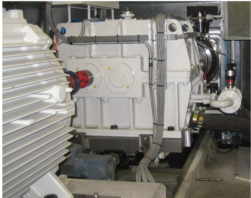
Antrieb mit Motor, Getriebe, Zwischenwelle und Verschiebeeinheit
