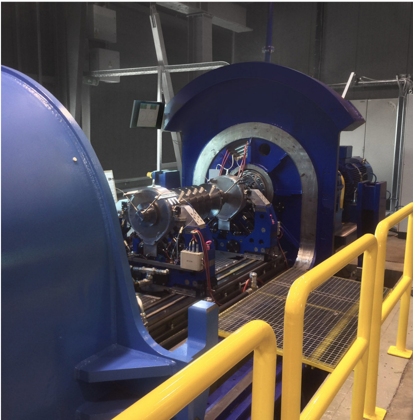
Hochtourige Auswuchtanlage HS 23 mit Vakuum-Sicherheitsbehälter für Radial-Turboverdichter
