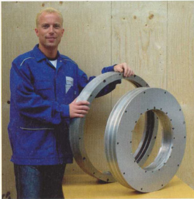
5 Auswuchtkopf für einen Großventilator 5 Balancing head for a large fan
