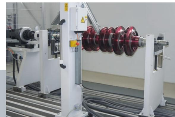
Runout-Überprüfung eines Turborotors
