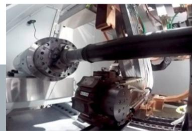
Auswuchtmaschine für Gelenkwellen
