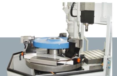
Auswuchtmaschine für Eisenbahnräder
