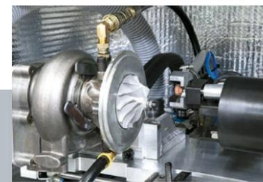
Auswuchtmaschine für Turbolader
