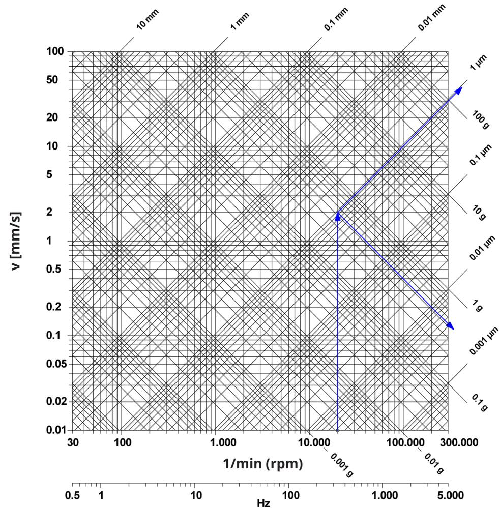
Beispiel: 2 mm/s Schwinggeschwindigkeit bei 20.000 1/min entsprechen ca. 0,95  $\mu\text{m}$  Schwingweg bzw. 0,42 g Schwingbeschleunigung.
